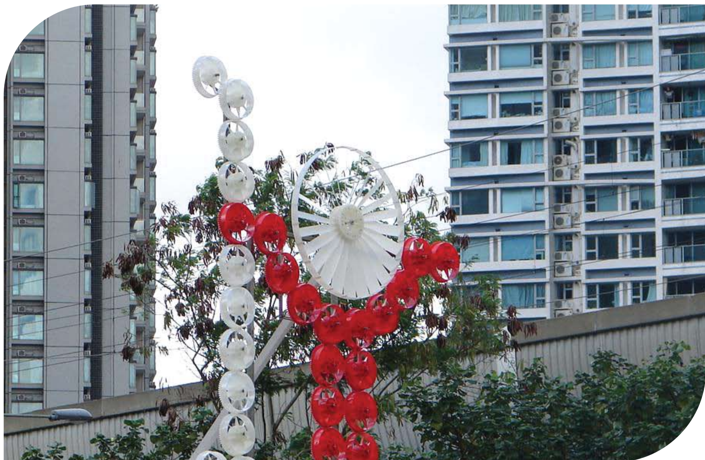
垂直軸風力發電風車 Vertical Wind Turbine
