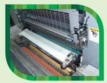
全面安裝自動洗車裝置,淘汰使用傳統有機溶劑清洗機器,避免揮發性有機化合物排放。 Installing automatic non-VOC blanket washing system to eliminate VOC emission.
