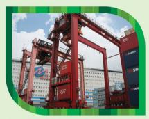
在2007年,44台柴油驅動龍門起重機改裝為以油電混合動力驅動,減少40%二氧化破排放量。 Modified 44 diesel-powerd RTGs into Hybrid RTGs in 2007, thus reducing 40% of CO<sub>2</sub> emission.
