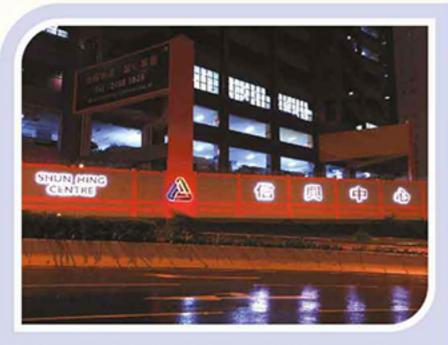
外牆的標誌由原本的射燈照射改用LED背燈襯托·並設有 戶外感光開關功能·大大減低用電量·而且更加美觀。
