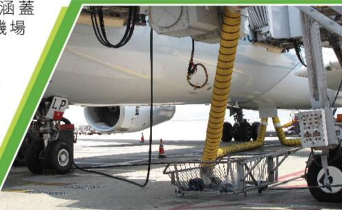
機管局在2014年底禁止飛機在停機位使用輔助動力裝置,飛機在停機位 需使用固定地面供電系統及預調空氣系統,減少使用燃油及降低排放。
