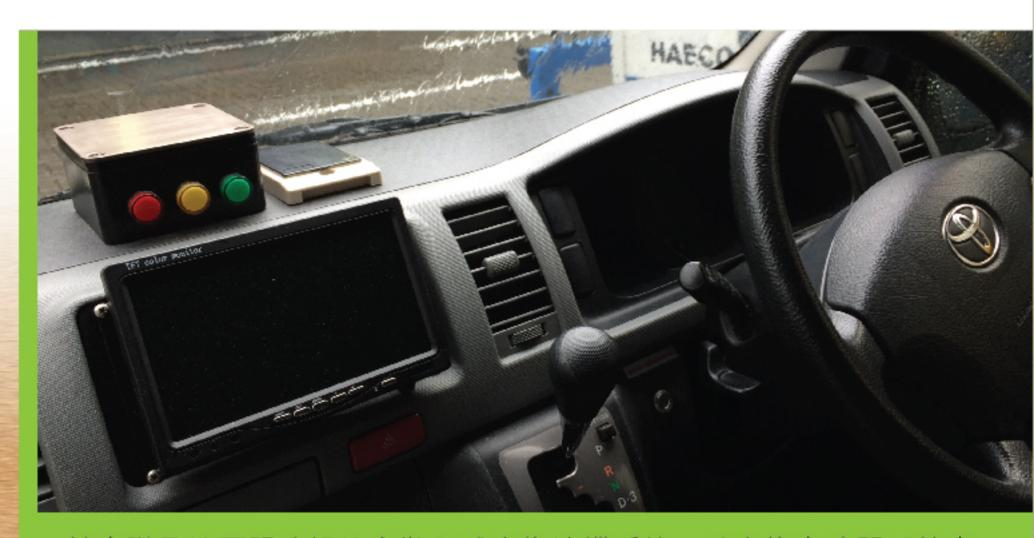
於車隊及地面服務設施安裝全球定位追縱系統,監察停車時間以節省 燃料用量。
