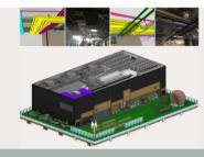
在規劃階段採用建築信息模型系統,以加強建築、 結構和機電設計之間的協調,從而解決設計上的 衝突,避免其後修整工序,加快施工進度和減少耗材。
