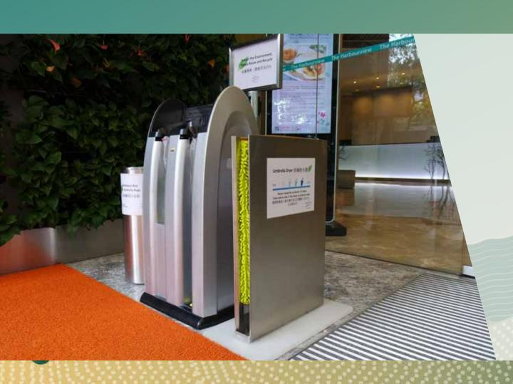
工程部團隊透過升級再造舊枕頭袋和廢棄木材等材料,研製了雨傘除水器,並將雨傘除水器放在大堂正門,每年可節省大約3 000個雨傘袋。
