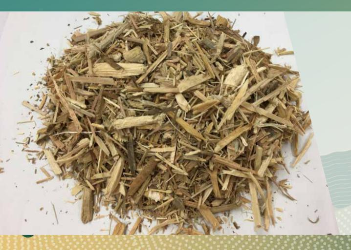
在2018年進行一項試驗計劃,在製造水泥時的窰爐加熱過程中以木材衍生燃料取代煤炭,以減輕香港的廢木材問題。
