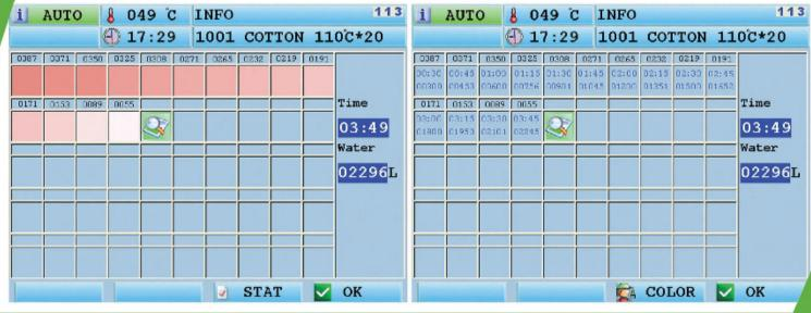
染色機顯示屏顯示取樣點當前指數及顏色,實時檢測水洗情況。
