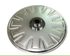
微風起動垂直軸風力發電系統配合專利無磁阻低扭力盤式發電機使用。 發電機的初始扭矩只需0.08Nm,遠低於傳統發電機最少0.29Nm的 初始扭矩。
