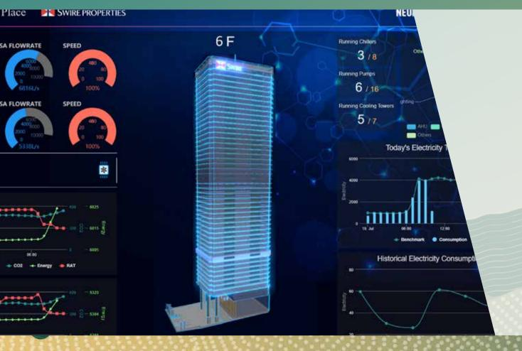
系統會不斷自動收集來自物聯網傳感器、實時運行監控和 視頻的數據。當與早期階段的建築信息模型空間數據輸入 共用時,系統可以將理想的效能使用與所有建築物服務設備 的當前使用之間的差距收窄至最少。
