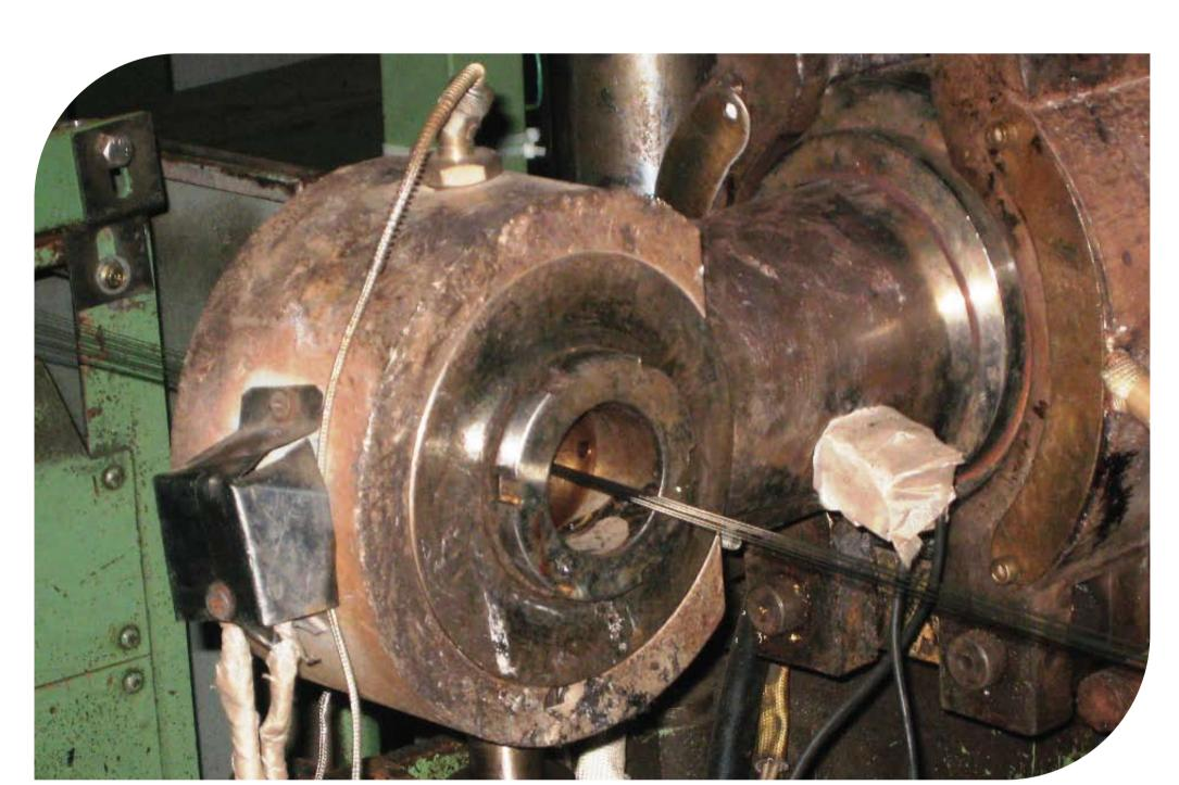
把原本暴露在外的機頭加熱器改裝在內部,減少熱能散失,節省用電。
