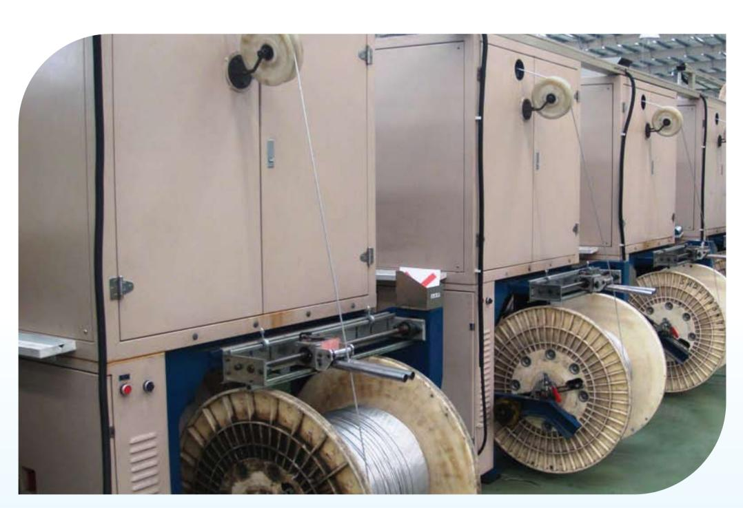
為部分產生高噪音的編織機安裝隔音罩,將車間噪音降低達約15dB。
