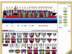
東方海外利用專業的貨櫃配載計算以達致最理想裝載平衡和最小倉庫水量，幫助降低船舶的油耗以減低排放。
