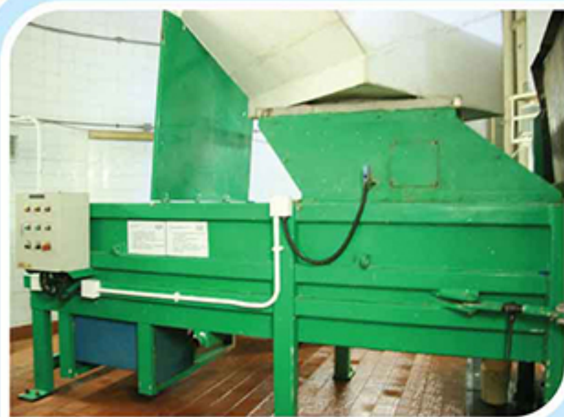
配備垃圾壓縮機，可將廢物體積減少七成五，減輕堆填區負荷。
