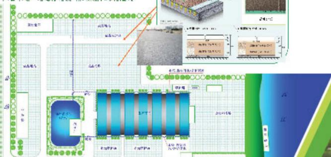
透水路面與雨水收集系統收集雨水循環使用。
