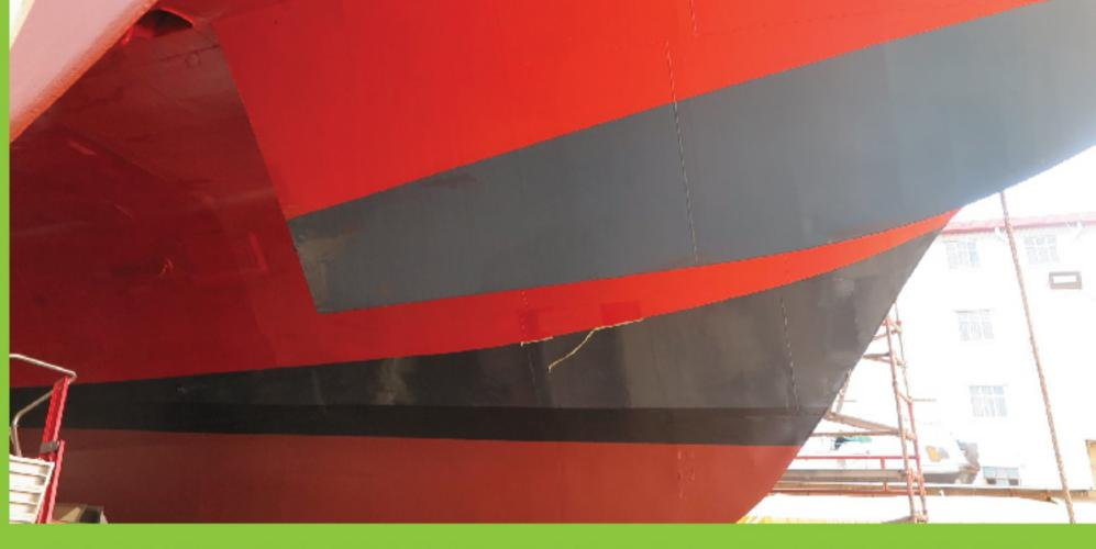
船身應用防污塗層以減少航行過程中的摩擦力,提高船舶的性能並降 低耗油量。
