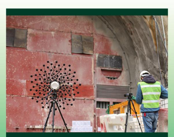
在隧道入口處設立隔音罩,並用聲學相機檢驗隔音罩 的聲學性能。
