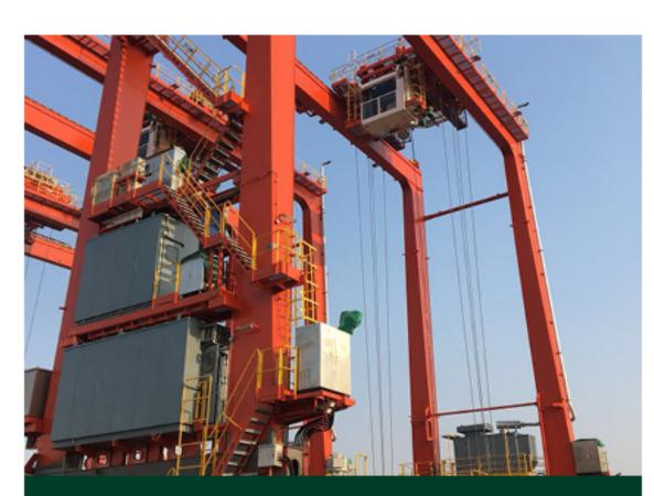
開發新型混能龍門吊機及提升電動龍門吊機使用率,從而減少運作時所需的柴油及能源。
