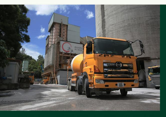
採用符合歐盟五期排放標準的混凝土攪拌運輸車,並每年檢查 工廠的所有貨車,以有效控制車隊的路邊排放量。
