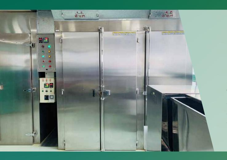
使用更高能源效益的焗爐,運作少四小時已能達到相同的 生產標準,因而能節省約10%的耗電量。焗爐亦安裝了計時 器,能夠於指定時間自動關閉,避免待機時浪費的能源。
